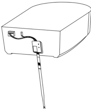
Am Gehäuse des Antriebes ankleben und Antenne nach unten, parallel zum geschlossenen Tor, ausrichten.
