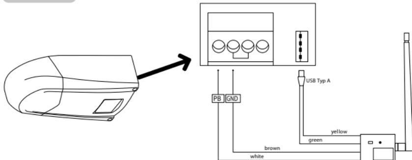
**B ELEKTRISCHER ANSCHLUSS AN ANDERE SCHELLENBERG GTA**
