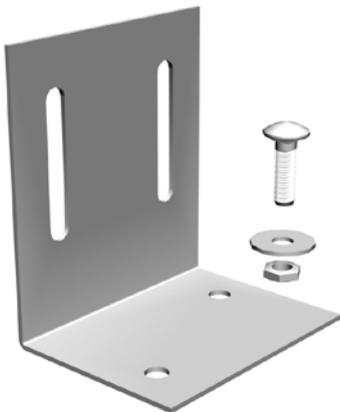
Mit Hilfe des Rigips Montagesatzes UA 100 werden Verbindungen und Anschlüsse von U-Aussteifungsprofilen 100/40-2 einfach hergestellt. Der Rigips Montagesatz für UA 100 besteht jeweils aus 4 Stück Anschlusswinkeln, Zargenschrauben M8, Sechskantmutter M8 und zugehörigen Unterlegscheiben der Öffnungsweite 8,5 mm. Die Abmessungen des Winkels sind auf das Rigips U-Aussteifungsprofil 75/40-2 abgestimmt.
