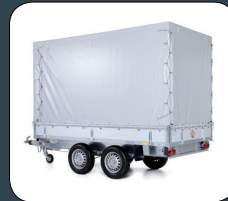
Hochspiegel mit Hochplane für wettergeschützten Transport (auch Flachplane möglich)
